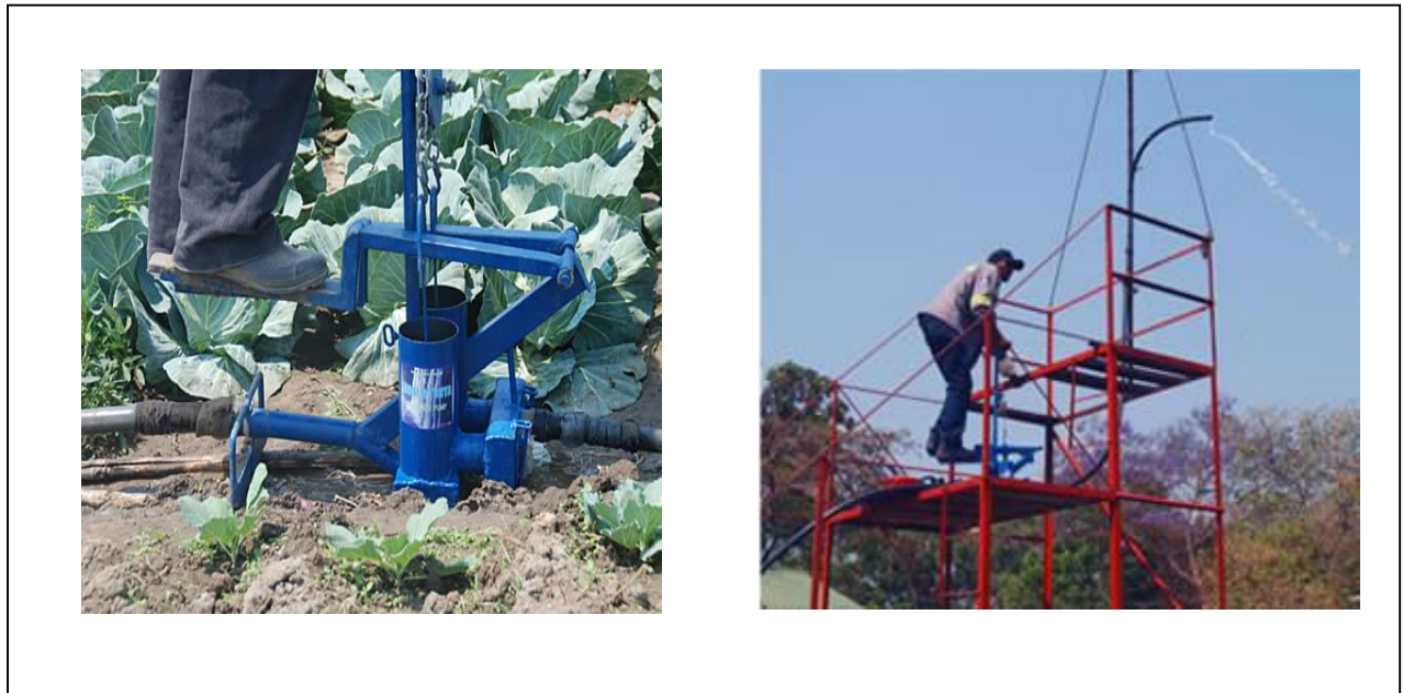
รูปที่ 6 เครื่องสูบน้ำแบบจักรถีบในประเทศแซมเบีย
