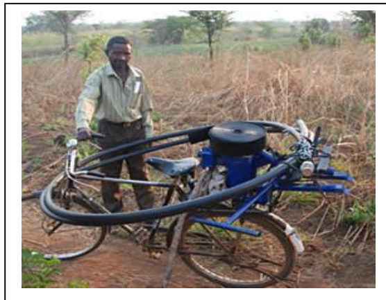
รูปที่ 7 การเคลื่อนย้ายเครื่องสูบน้ำแบบจักรถีบ (Treadle Pump)
