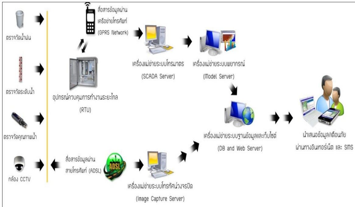
รูปที่ 5 ระบบตรวจวัดสภาพน้ำทางไกลอัตโนมัติ
