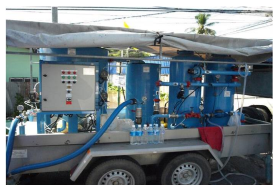
รูปที่ 11 รถบรรทุกน้ำ และเครื่องผลิตน้ำประปา
