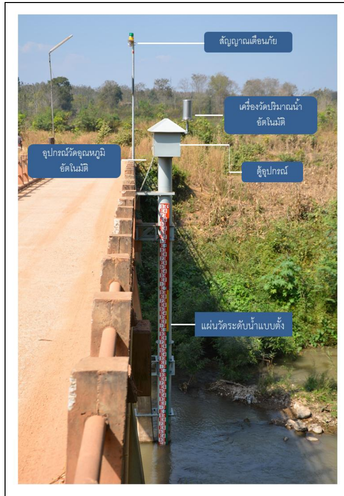
รูปที่ 4 แบบสถานีเตือนภัยด้วยระดับน้ำและปริมาณน้ำฝน
