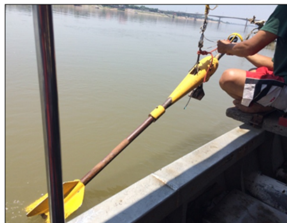
รูปที่ 2-5 เครื่องวัดกระแสแบบกรวยหมุน สำรวจแม่น้ำโขงบริเวณพื้นที่ศูนย์อุทกวิทยา จังหวัดหนองคาย
