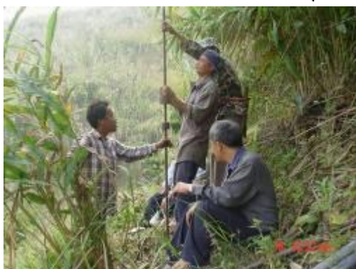
การทดสอบกำลังรับน้ำหนักของชั้นดิน
