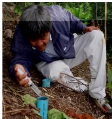
รูปที่ 3.3 ไคอะแกรมการทดสอบการรั่วซึมน้ำ และตัวอย่างการทดสอบในสนาม
