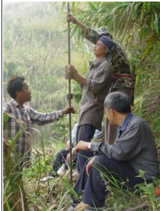
รูปที่ 3.2 แสดงเครื่องมือทดสอบ และตัวอย่างการตอกทดสอบในสนาม
