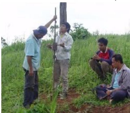
การทดสอบกำลังรับน้ำหนักของชั้นดิน
