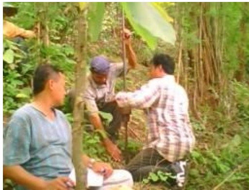
การทดสอบกำลังรับน้ำหนักของชั้นดิน
