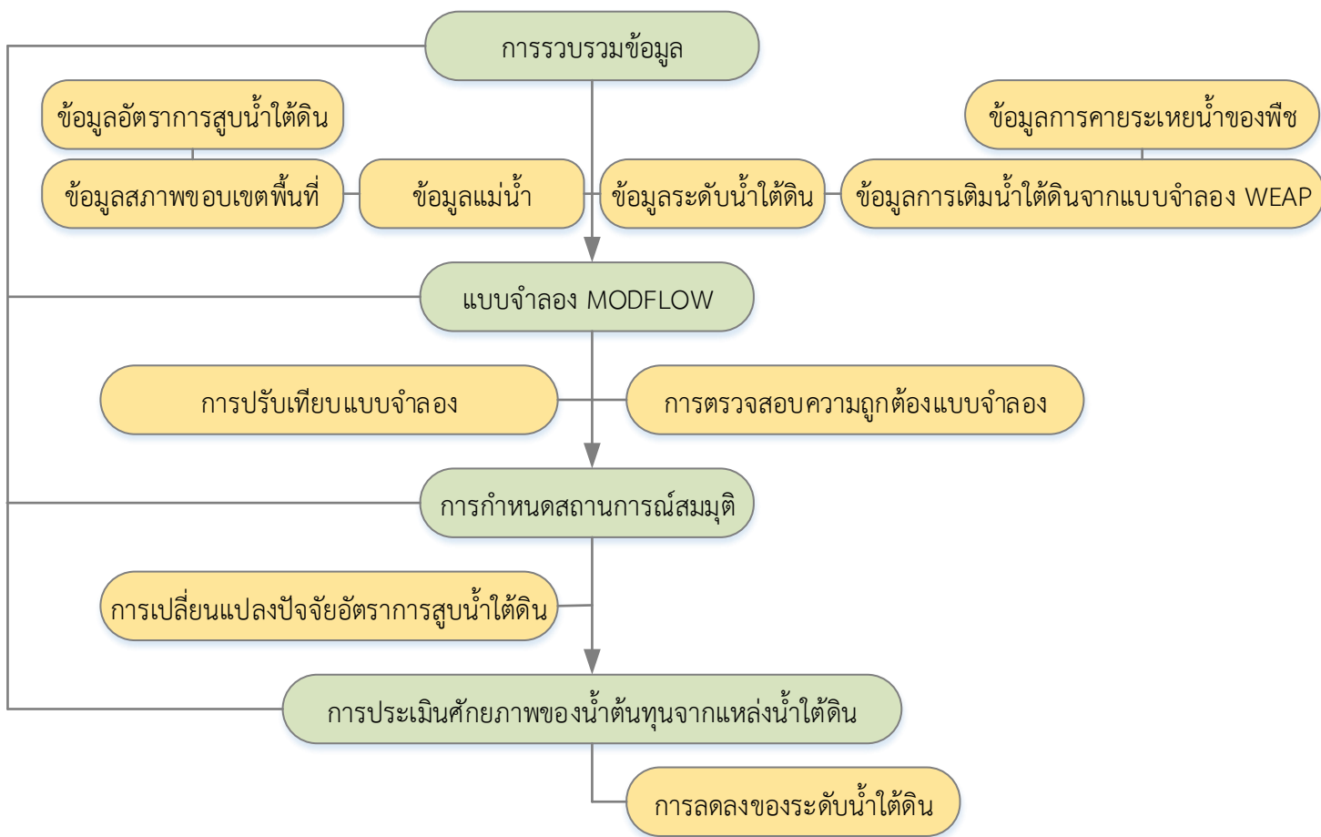
รูปที่ 3-4 ขั้นตอนการสร้างแบบจำลอง VISUAL MODFLOW และรายละเอียดขั้นตอนการประเมินศักยภาพของน้ำต้นทุนจากแหล่งน้ำใต้ดิน
