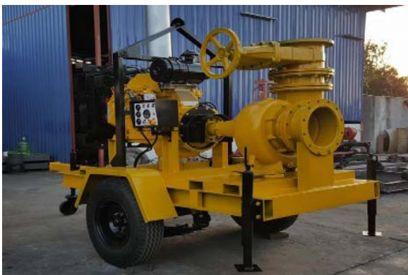
เครื่องสูบน้ำขับเคลื่อนด้วยเครื่องยนต์ดีเซล ขนาด 30 นิ้ว
