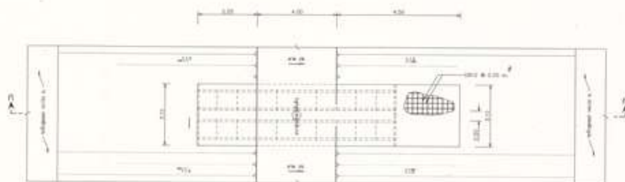
แบบแผนการวางท่อ 2 แถว ขนาด Ø 0.80 m.
