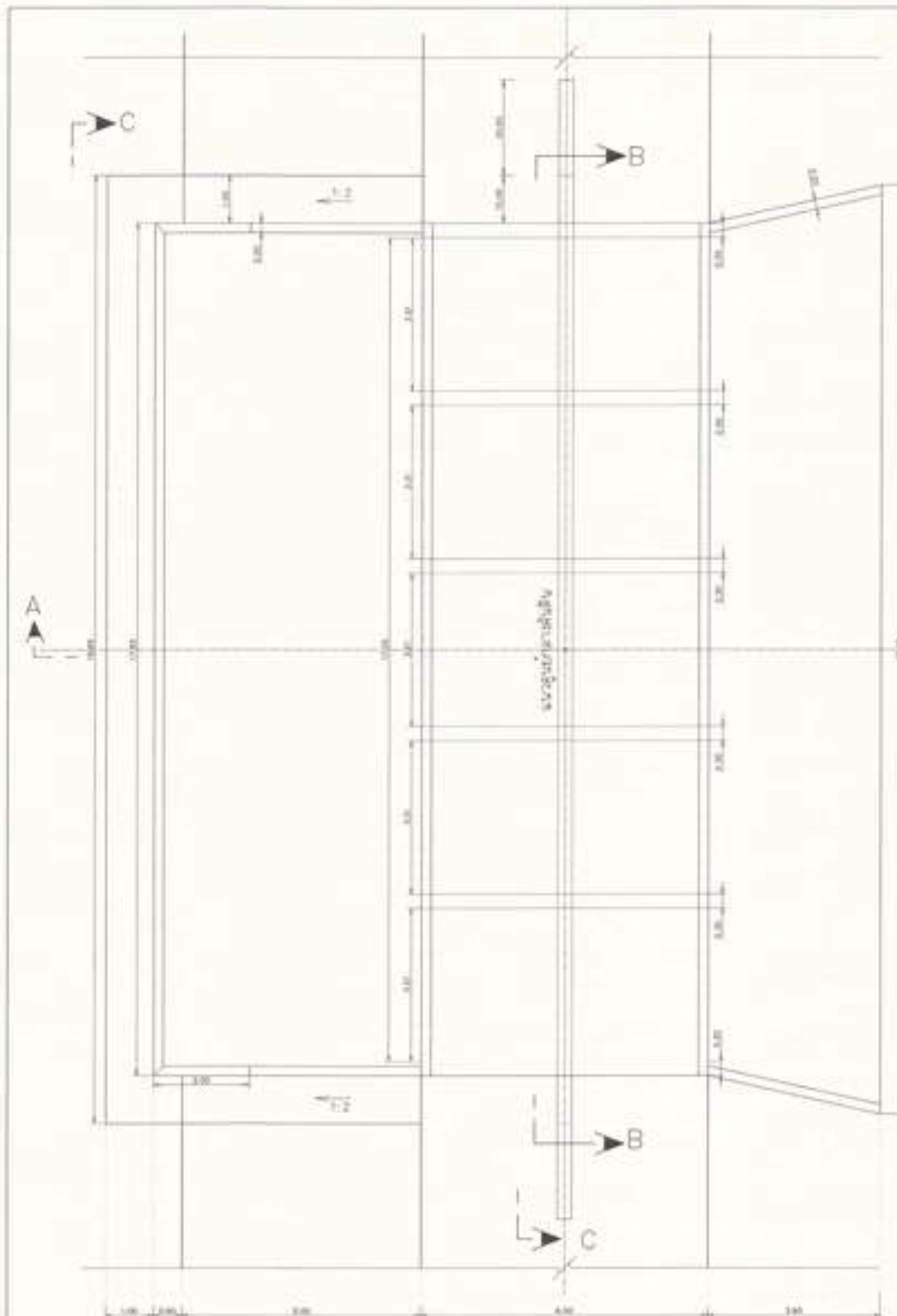
แบบขยายท่อเหลี่ยม คลล.ทางน้ำไหลเข้าเป็นกล่อง ขนาดย่อ 1:50
