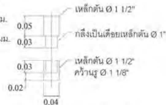
แบบขยายบานพับรั้วเหล็ก
