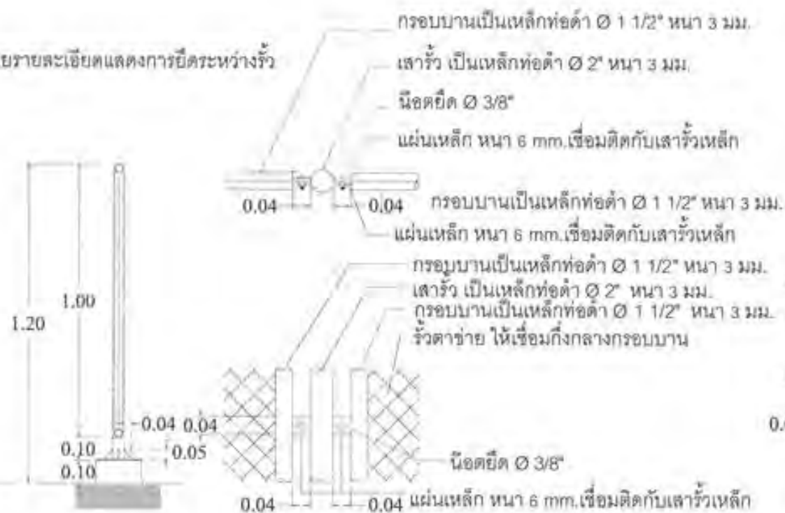
รูปตัด A แบบขยายรายละเอียดแสดงการยึดระหว่างรั้วกับเสา
