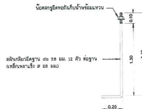
แบบขยายหลักเกลิวยึดฐาน
