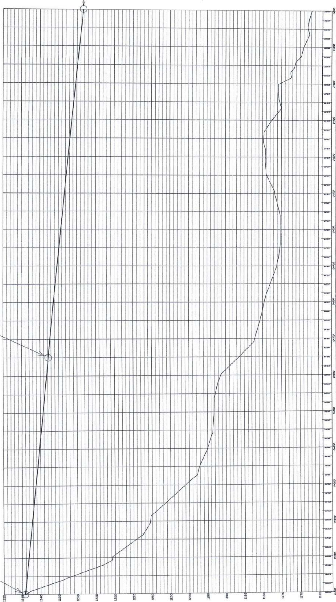
รูปตัดตามแนวยาวแสดง H.G.L. สาย 1LMP STA. 0+000 - 1+600
