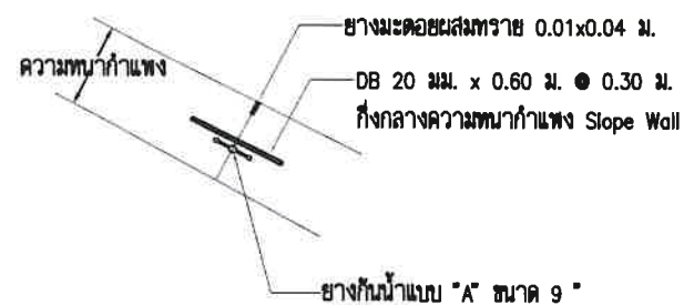
แบบขยายรอยต่อกำแพง 1 SCALE 1:50
