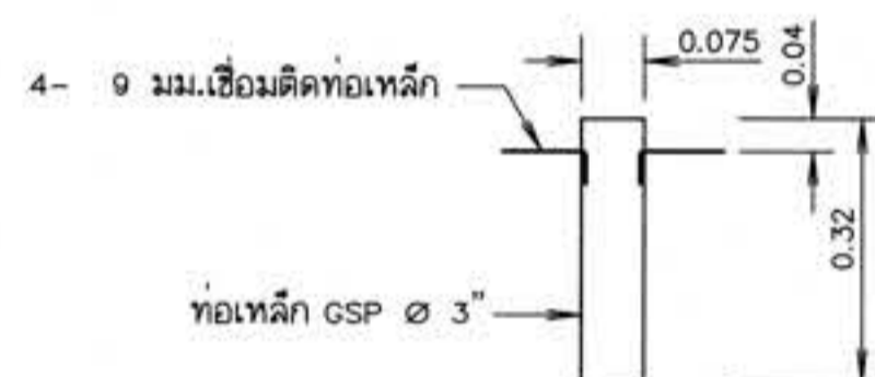
ทอระบายน้ำ
