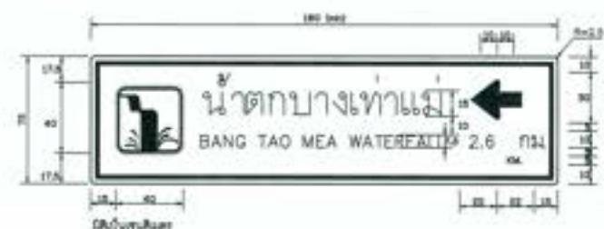
แสดงขนาดป้ายและภาพสัญลักษณ์ (ท-2) ไม่แสดงขนาดตัว
