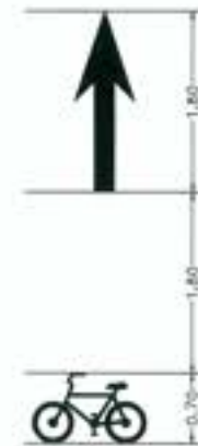
แปลนขยายสัญลักษณ์ ตำแหน่งจักรยานและลูกศร มาตราส่วน 1:40
