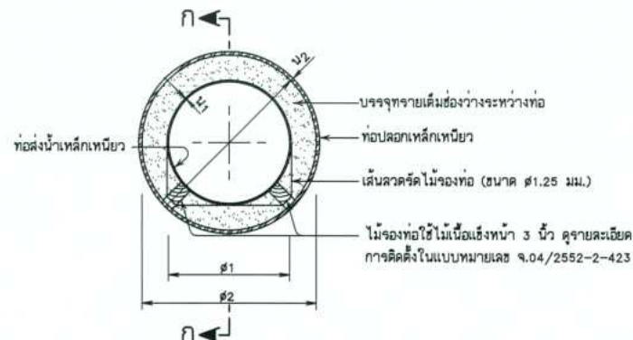
การดันท่อลอดถนนแบบที่ 1 ไม่แสดงมาตราส่วน
