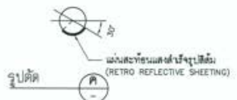
รายละเอียดการทาสีและการติดตั้งแผ่นสะท้อนแสงที่ โคมเสา
