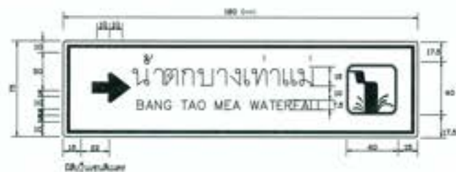
แสดงขนาดป้ายและภาพสัญลักษณ์ (ท-1) ไม่แสดงขนาดตัว
