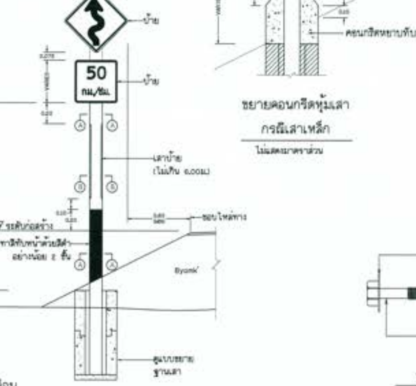
แสดงการติดตั้งโครงเหล็กกล่องกับเสาป้าย
