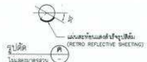
รายละเอียดการทาสีและการติดตั้งแผ่นสะท้อนแสงที่โคนเสา
