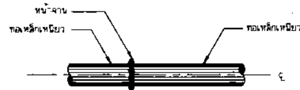
การบรรจุท่อเหล็กเหนียวกับท่อเหล็กเหนียว
