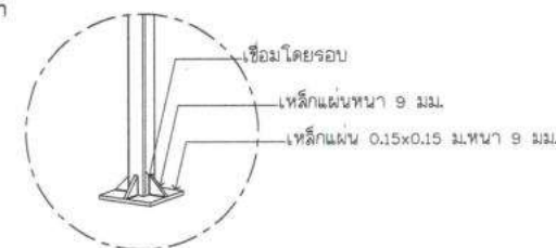
แบบขยายขาเสา มาตราส่วน No Scale
