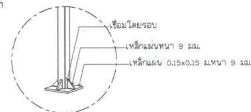
แบบขยายขาเสาหล่อปูน มาตราส่วน No Scale
