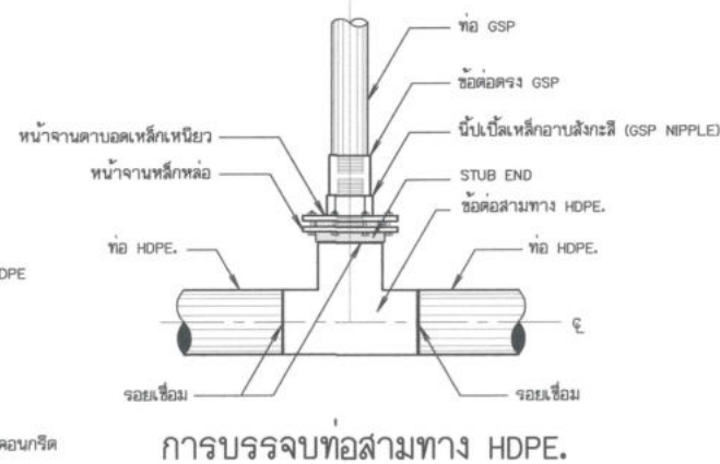
รูปตัดอาคารท่อระบายอากาศ Ø 50 มม. (ใช้สำหรับท่อส่งน้ำที่มีขนาดไม่เกิน 6 นิ้ว) มาตราส่วน
