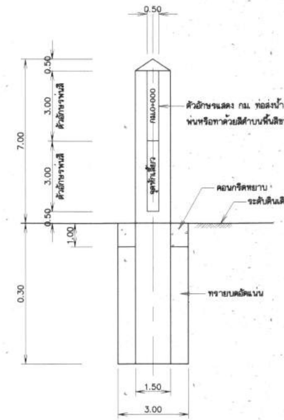
รูปตัด ก-ก แบบที่ 2 แสดงจุดหักเหของท่อ ไม่แสดงมาตราส่วน
