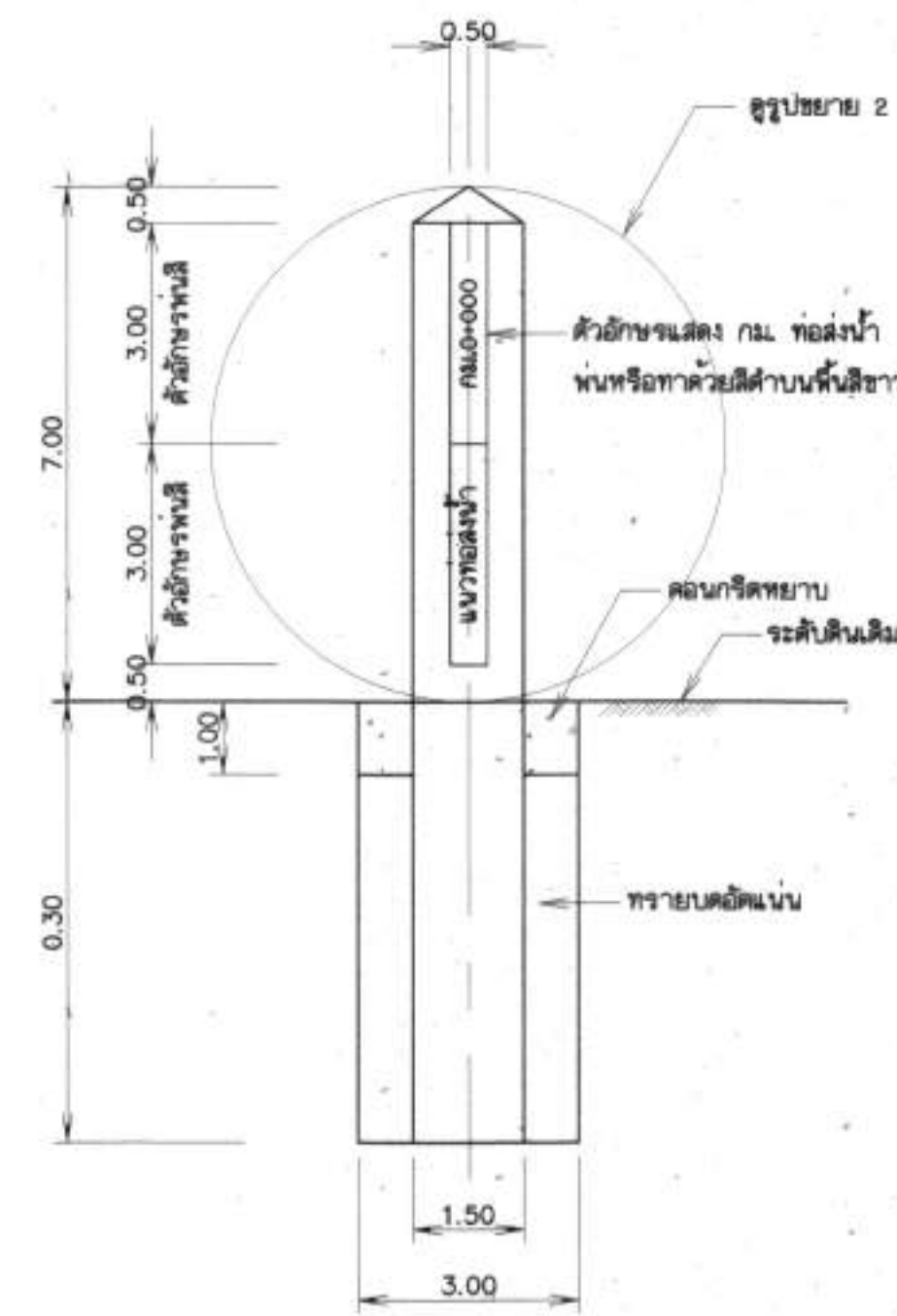
รูปตัด ก-ก แบบที่ 1 แสดง ก.ม. ท่อลงน้ำ ไม่แสดงมาตราส่วน
