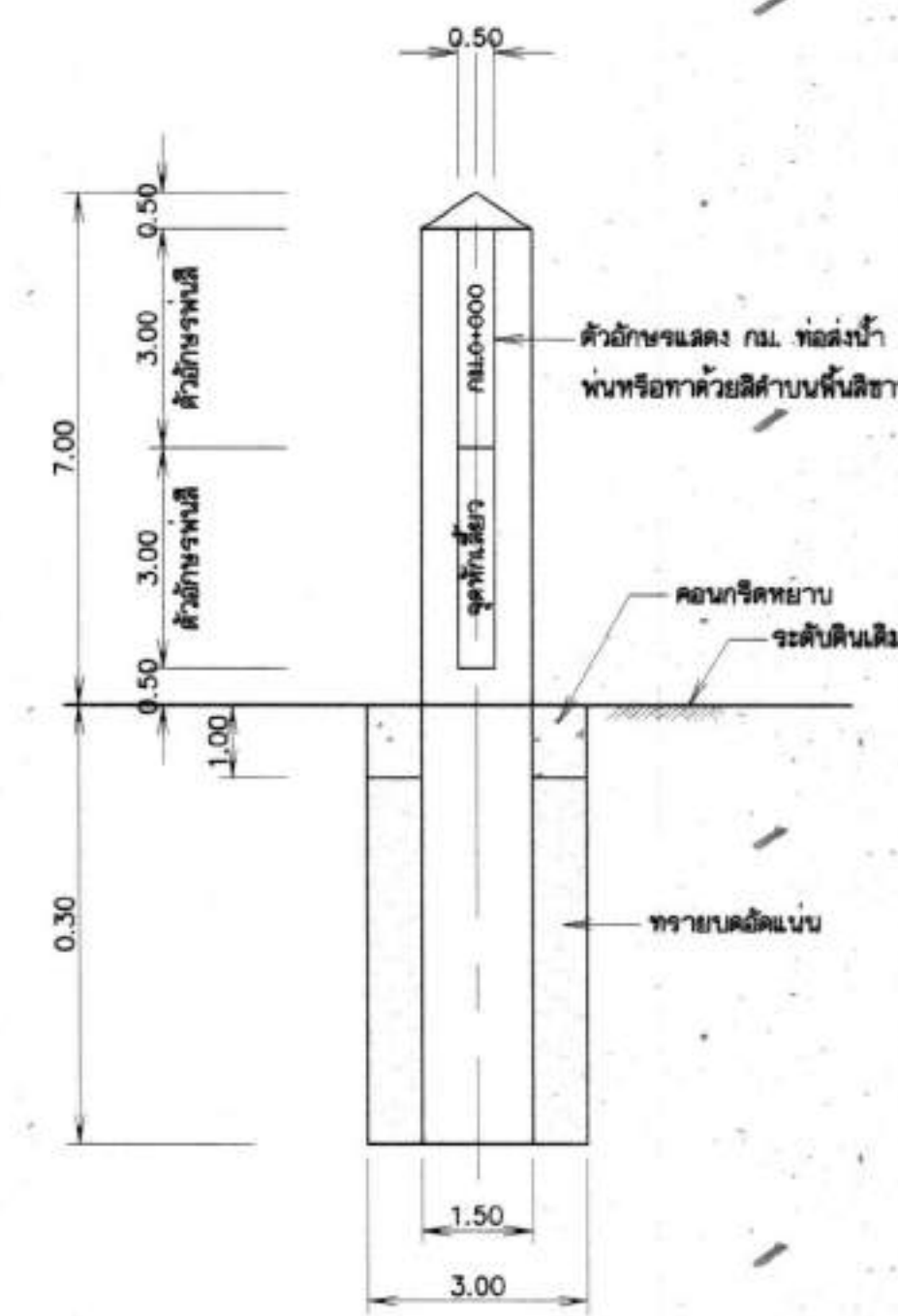
รูปตัด ก-ก แบบที่ 2 แสดงจุดหักเห ไม่แสดงขนาดราวล้วน
