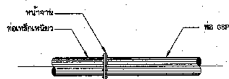
การบรรจบท่อเหล็กเหนียวกับท่อ GSP.
