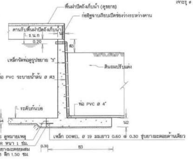
รูปตัดท่อรับน้ำหรือท่อระบายน้ำ มาตราส่วน 1:50
