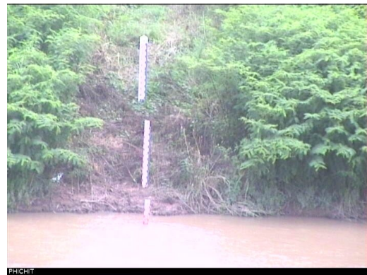
ระดับวิกฤติน้ำแล้ง <27.59 ม.รทก., วิกฤติน้ำท่วม >36.21 ม.รทก. สถานการณ์น้ำ : ฝ่าวรังกาน้ำแล้ง ระดับน้ำปัจจุบัน = 28.23 ม.รทก.
