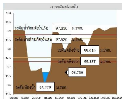
สถานีแม่น้ำทับเสาที่สะพานข้ามแม่น้ำทับเสา (กม.27+850)
